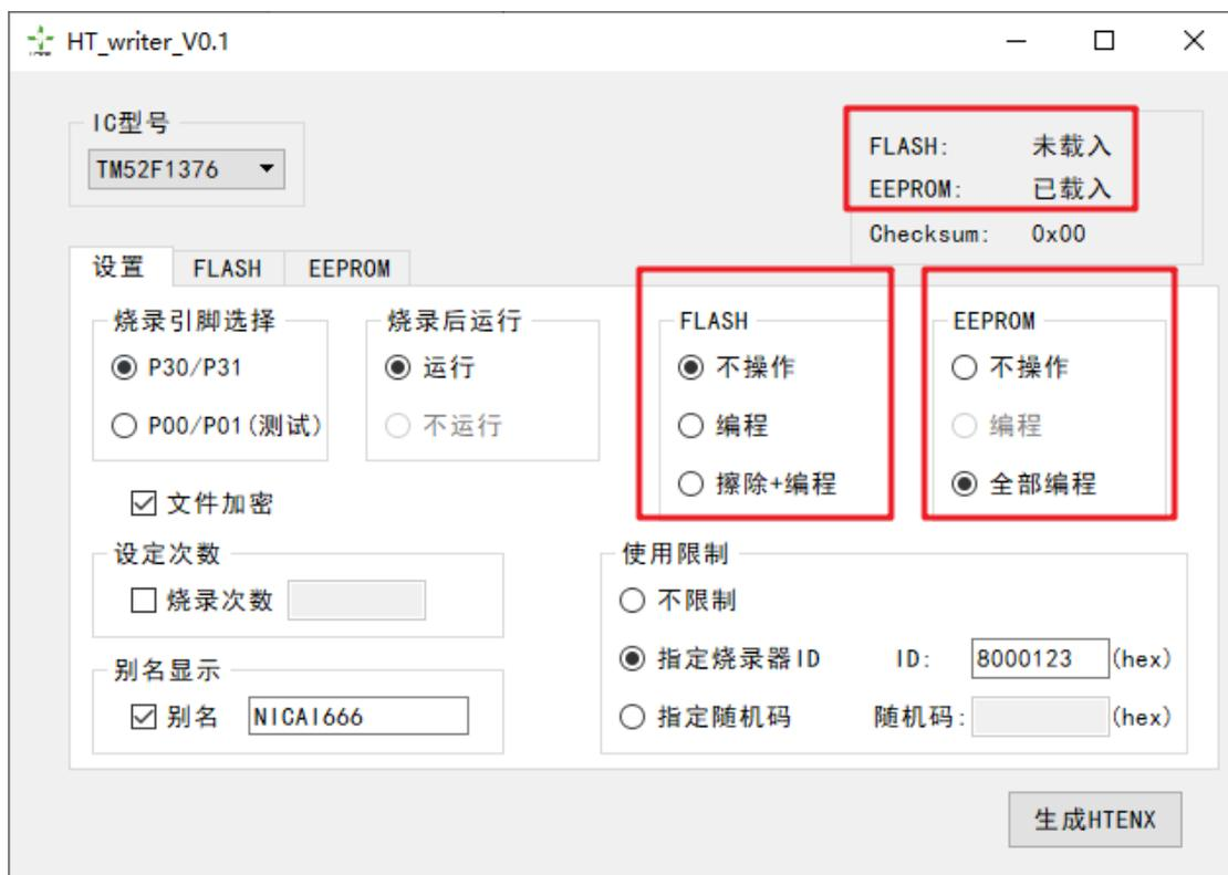
因为工具支持单独烧录 EEPROM，用户可在 MCU 程序中执行功能选择（提供 EEPROM 的特定地址内容不同配置不同的功能），首先自行进行 flash 烧录（如机台烧录空片）。在芯片提供给用户生产后，再提供给用户 EEPROM 在板烧录文件，达到配置功能/开启功能等操作。
